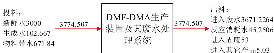
图 3-3 N,N-二甲基甲酰胺二甲基缩醛产品物料平衡图 单位：单线 kg/批次
