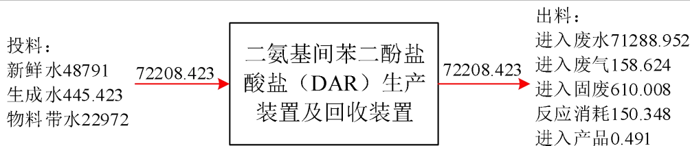
图 3-5 二氨基间苯二酚盐（DAR）产品物料平衡图 单位：单线 kg/批次
